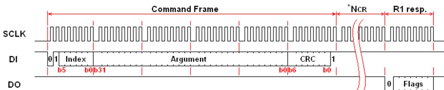
Как видно из рисунка выше, есть 2 линии данных (**DI** и **DO**). Передача по ним идет синхронно и одновременно в обе стороны. Запись/чтение очередного байта инициирует 8 тактирований сигнала **SCLK** и соответственно передачу по 8 бит в каждую сторону. При чтении из порта данных оные забираются из буфера, в ответ полученному байту карте уходит #FF. При записи же байта в порт данных оный передается на линию **DI** начиная от старшего бита к младшему.
